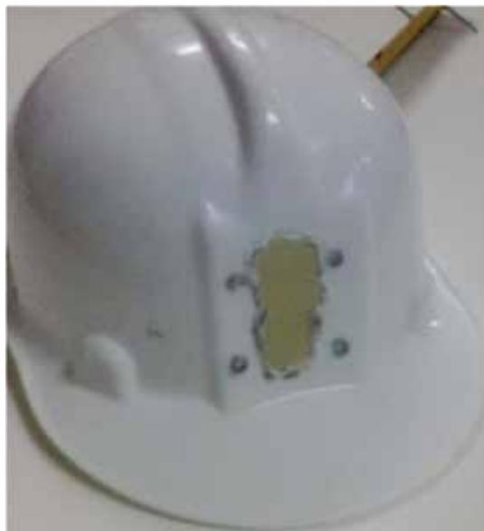
Figura 4 – Capacete perfurado para teste dos interruptores
