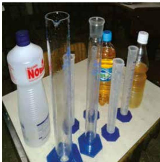
Figura 6 – Material para experimento de teor de álcool na gasolina
