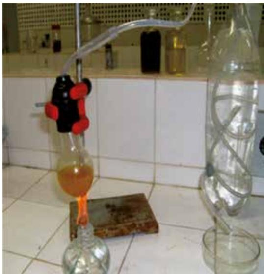
Figura 5 – Destilação com materiais alternativos.
